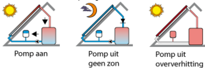
Afb. 5.1 Drukgevuld systeem: collector hoeft niet hoger te liggen dan het opslagvat
