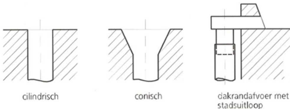
Afb. 10.5 Verschillende uitvoeringen van dakafvoeren voor overlaatstroming
