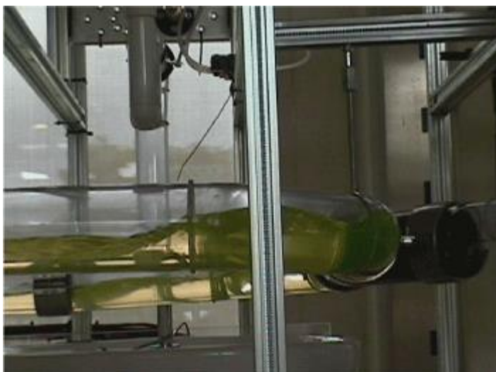
Afb. 4.9 Ter plaatse van een bocht treedt opstuwing op
