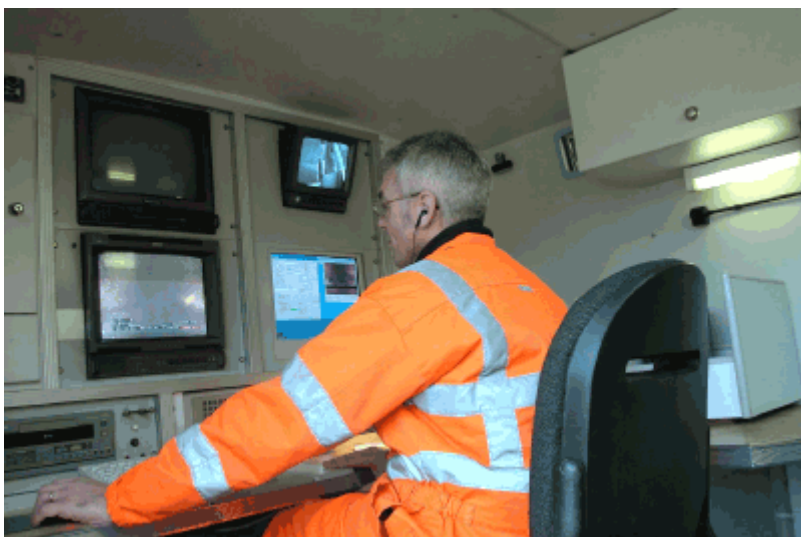
Afb. 17.4 Vastleggen beelden van camera-onderzoek riolering in televisiewagen
